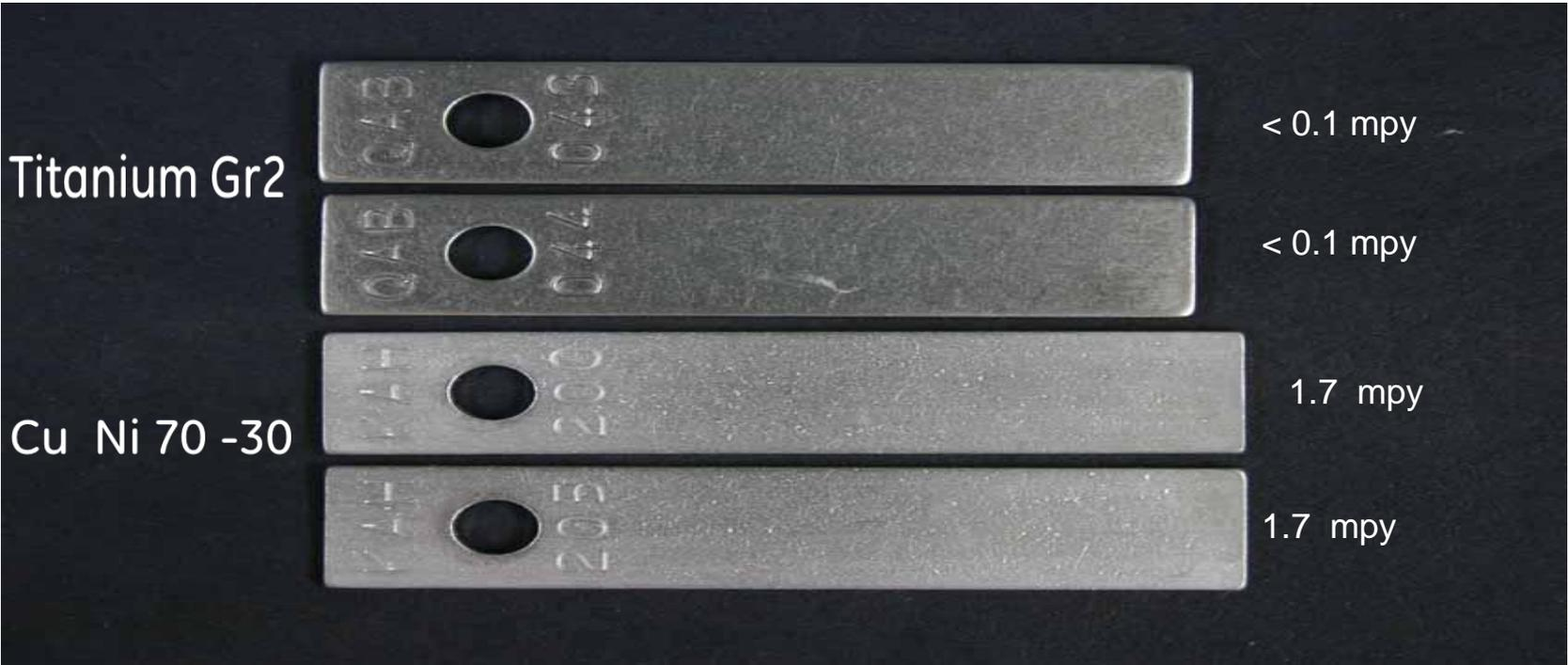
CRM probe corrosion Cu/ Ni 70-30 : 0.9 mpy
